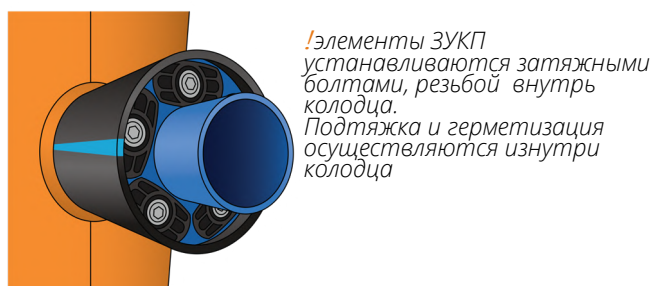
Рисунок: Втулка прохода с подключением через ЗУКП
