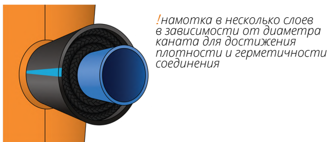
Рисунок: Втулка прохода с применением кабелки
